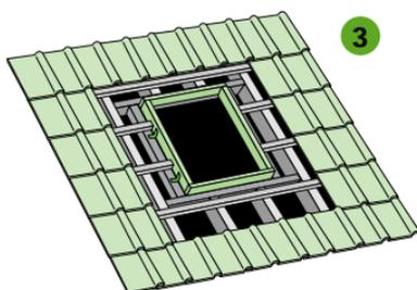
4 Controlar el nivel para garantizar que el marco no está deformado (las diagonales A y B deben ser idénticas). Comprobar igualmente el paralelismo entre el marco y los cabrios.
